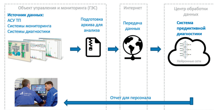
Рис. 3. Пример офлайн диагностики оборудования электростанции
